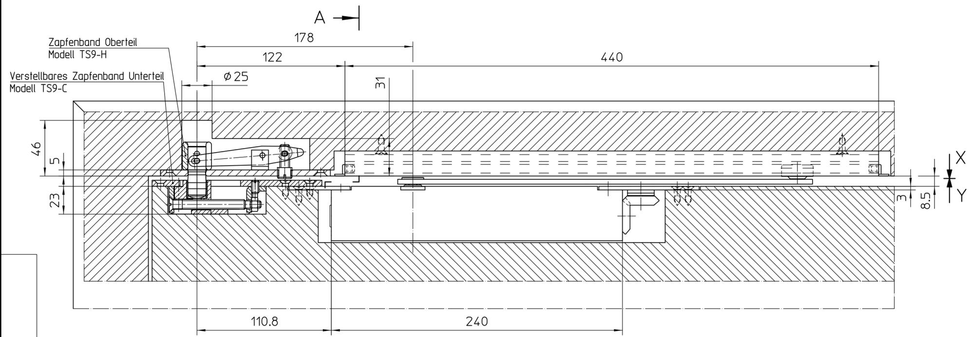
Maße GEZE Boxer Gr. 2-4 mit Gleitschiene 12mm
