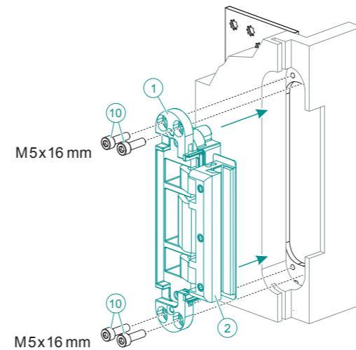
**DE** TE 340 3D FZ rückseitig an der Zarge verschrauben. Das Band-Rahmene teil ① mit den 4 Schrauben ⑩ an TE 340 3D FZ befestigen (8 Nm).
