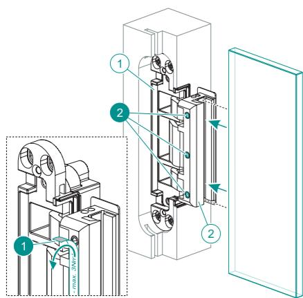
**DE** Den Aufkleber ① entfernen. Die Klemmfläche muss sauber und fettfrei sein! Den Türflügel bis zum Anschlag in das Band-Flügelteil ② einschieben, in der Höhe ausrichten und mit den 3 Schrauben ② festziehen (2,5 bis 3 Nm). Auf ausreichend Bodenluft achten!
