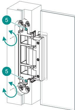
**Seitenverstellung / Side adjustment / Réglage latéral / Ajuste lateral:**
