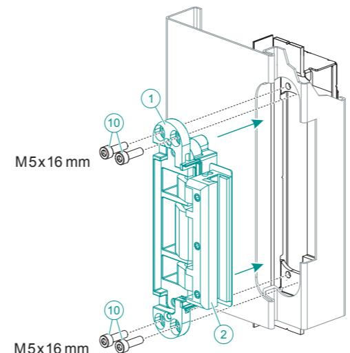
**DE** Die Stahlzarge muss mit TEG 310 2D SZ ausgestattet sein. Das Band-Rahmene teil ① mit den 4 Schrauben ⑩ an TEG 310 2D SZ befestigen (8 Nm).
