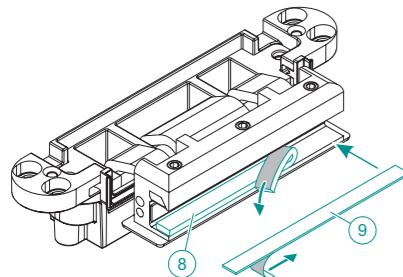
**DE** Das Band ist für 8 mm dicke Türflügel vormontiert. Bei 10 mm dicken Türflügel die Zwischenlage ⑧ rückstandslos entfernen und dafür ⑨ einkleben.
