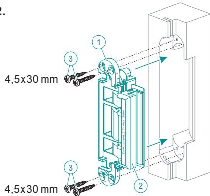
**DE** Das Band-Rahmeneteil ① in die Zarge einsetzen, die Zarge vorbohren und das Band-Rahmene teil mit den 4 Schrauben ③ befestigen.
