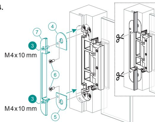
**DE** Die Abdeckplättchen ④ und ⑤ mit den Schrauben ⑥ auf dem Band befestigen. Die Falzabdeckung ⑦ mit den 2 Schrauben ③ bündig zur Zarge auf den Abdeckplättchen befestigen. Die Türdichtung einkürzen.
